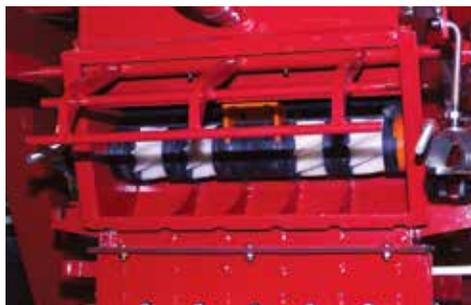
en option pour les semences de petite taille. La roue de dosage, à cannelure en spirale brevetée, tourne doucement et crée un flux régulier de semences dans le flux d'air. Cette conception unique élimine la nécessité de changer les roues et réduit les risques de dommage des semences et de dosage inégal.
