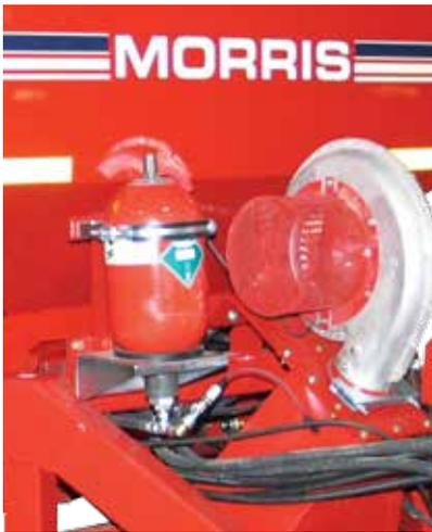
La pression est maintenue sur les vérins des éléments semeurs par un système accumulateur hydraulique passif qui agit comme un amortisseur hydraulique pour les dents et réduit les besoins en huile de 5 à 10 L. La pression d'huile de l'accumulateur peut être réglée, ce qui agit sur la pression des dents et leur déclenchement et sur la pression de compactage.
