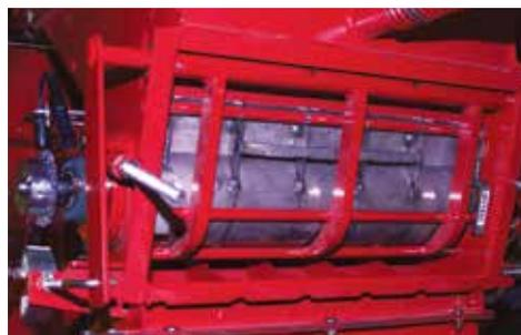
Une seule plaque de semence calibrée à changer, en fonction de la taille des grains à semer pour gagner du temps. Une fermeture par glissière de tous les réservoirs permet d'accéder aux différents réglages de distribution sans avoir à vider les réservoirs.
