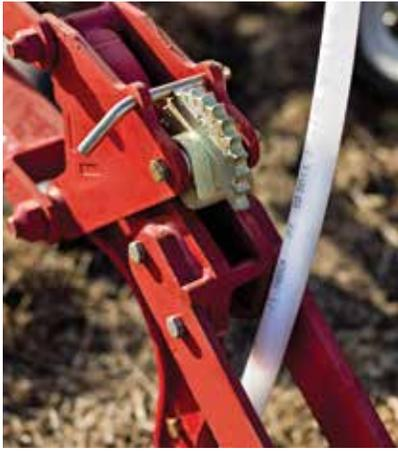
Réglage de la profondeur de semis simple, sans outil. Le système de réglage de la profondeur, à came et broche, est très accessible sur le haut de la dent à l'abri des jets de terre. L'intervalle des encoches est de 6 mm. Tourner la came à la main et insérez la goupille pour verrouiller à la profondeur de semis désirée.
