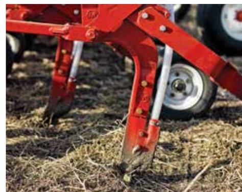
Chaque élément semeur suit le contour du sol, même sur les collines. La pression réglable de la roue «packer» de compactage en ligne assure un excellent contact semence-sol. La conception des éléments semeurs du semoir permet un meilleur dégagement des résidus et demande moins de puissance ce qui procure une économie de carburant.
